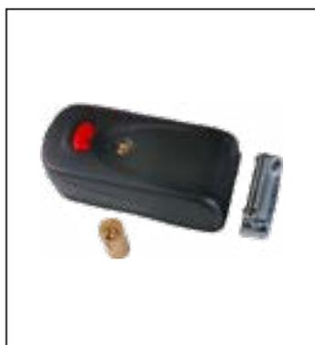
Scudo di protezione in acciaio verniciato. Bocchette in metallo con perno oscillante in inox. Catenaccio a gancio rotante in alluminio estruso. Tensione 12 V ca CE. Corrente assorbita 3A. Reversibilità ed entrata variabile da 50 a 80 mm.
